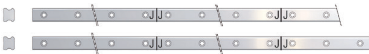
Figure 3.6 Identification des rails aboutés
