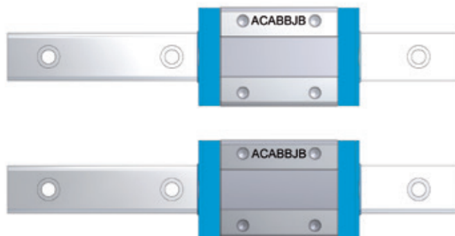
Figure 3.4 Identification de guidages linéaires montés en parallèle
